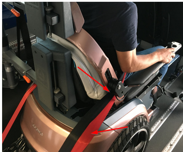
Abbildung 71. Korrekte Gurtführung des Becken- (rot) und 3-Punkt-Gurtes (schwarz) zur Sicherung des Benutzers
