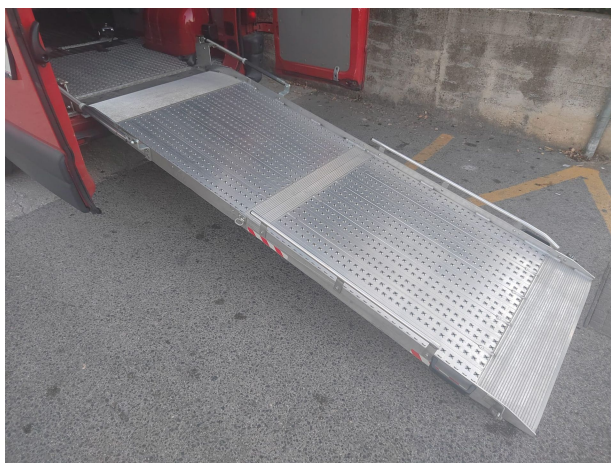
Abbildung 69. Gefährliche, steile Klapprampe mit Schwellen oben
